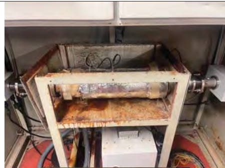
ตรวจสอบสภาพภายใน chamber , PT100 sensor
